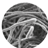
Visão da face do Filtro Poliéster Convencional ampliado 100x
