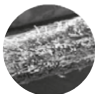
Visão da face do Poliéster Spunbond ampliado 50x
