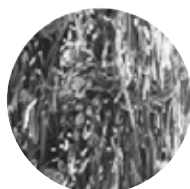
Visão da face do Filtro Poliéster Convencional ampliado 50x
