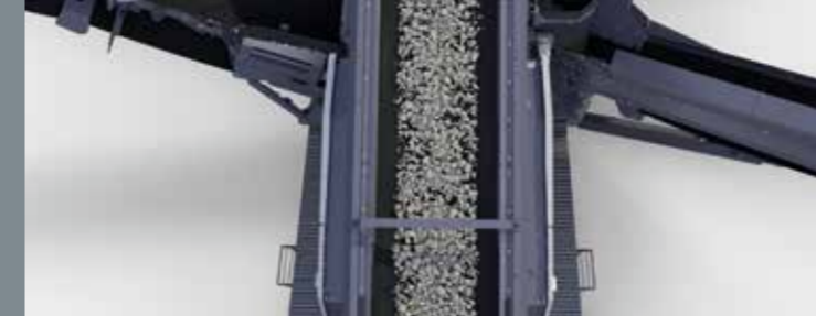
Cinta de alimentación extra ancha
