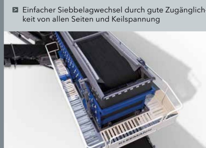
Aufstieg mit umlaufender Arbeitsbühne
