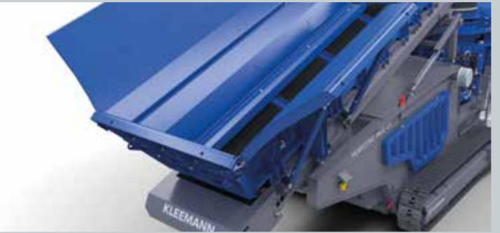
Sistema de traslación del material para favorecer el ángulo de descarga del material
