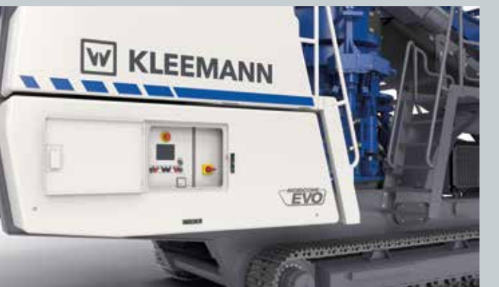
Boa acessibilidade devido à tampa separada no armário de distribuição
