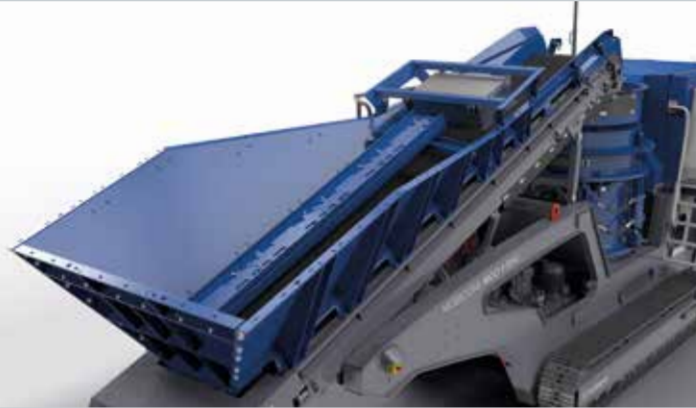
Unidad de alimentación con barra de descarga
