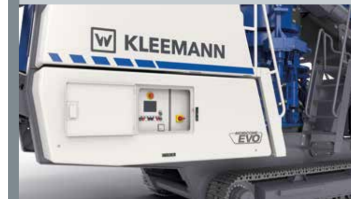
Accès optimisé grâce à un volet séparé sur le capot
