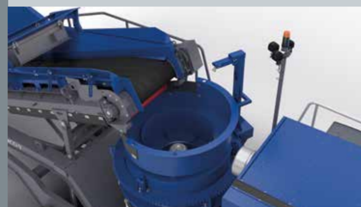
CFS pour un niveau de remplissage du broyeur à cône optimal
