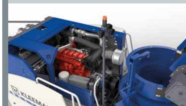
Entraînement diesel-direct-électrique puissant à rendement élevé
