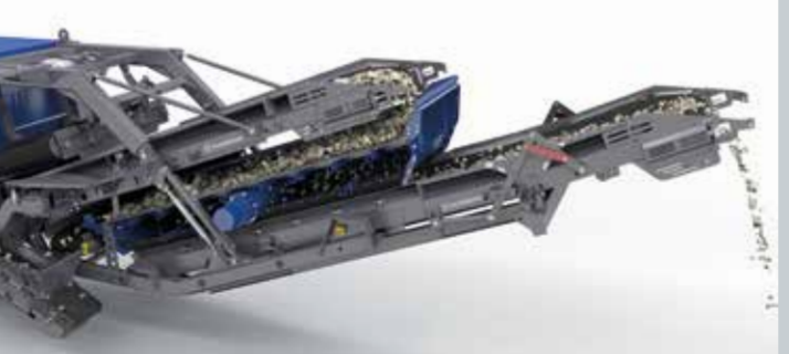
Criba vibrante con superficie de cribado extragrande
