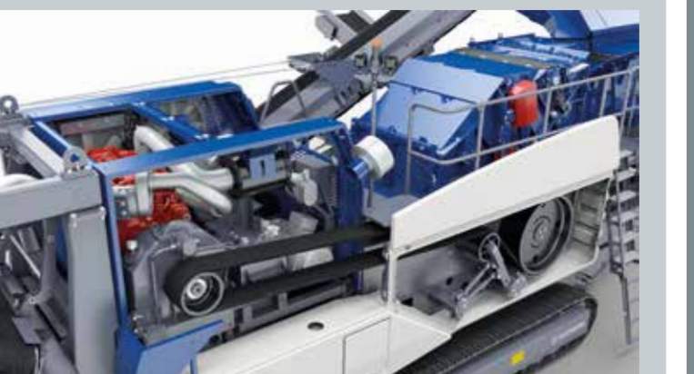
Accionamiento directo de la machacadora mediante acoplamiento hidráulico
