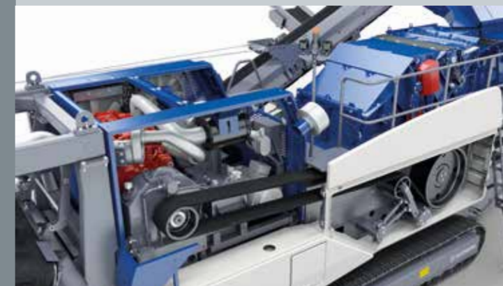
Entraînement direct du broyeur par coupleur hydraulique
