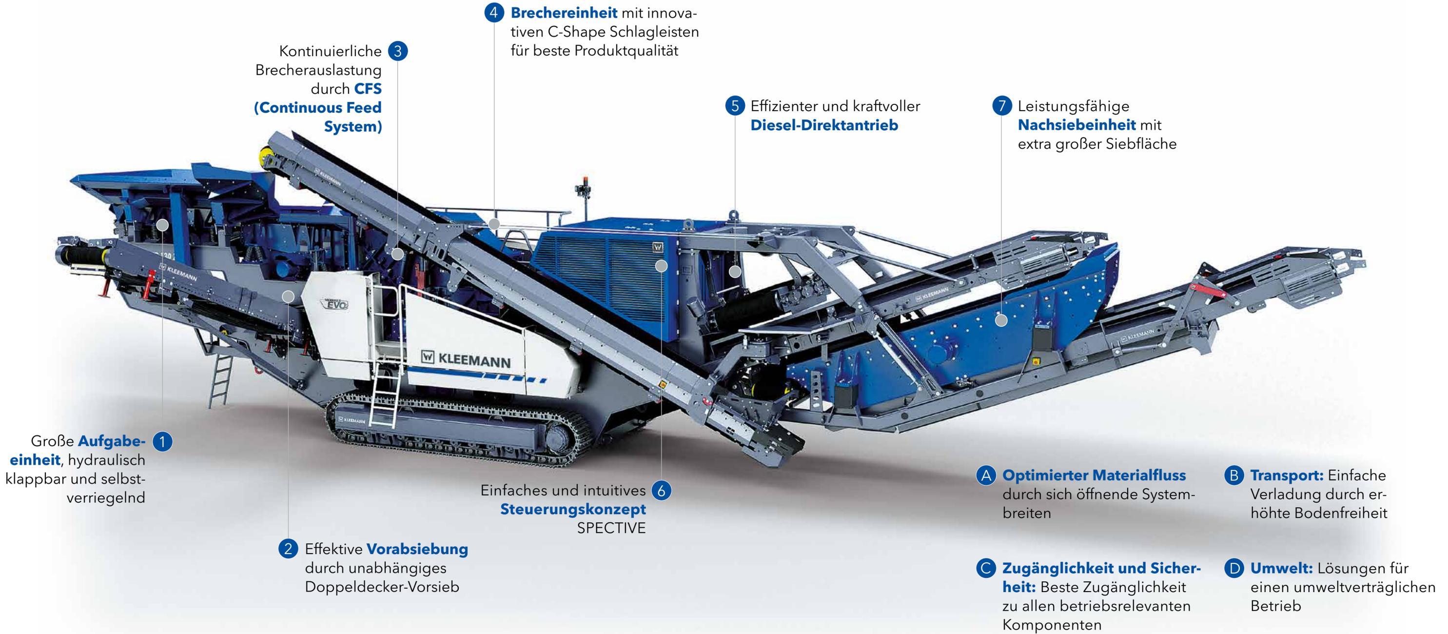
1 Große **Aufgabeneinheit**, hydraulisch klappbar und selbstverriegelnd
