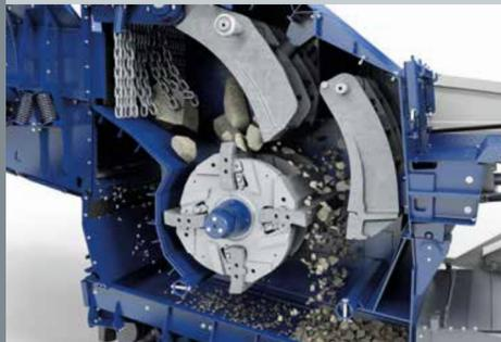
Brechereinheit mit optimierter Einlaufgeometrie
