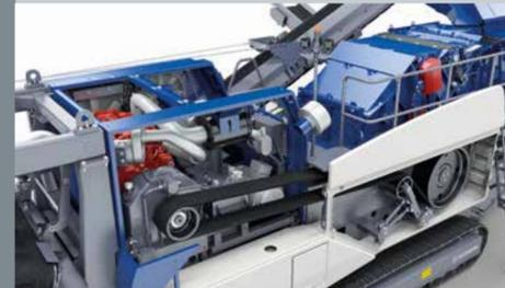
Brecher-Direktantrieb via Fluidkupplung
