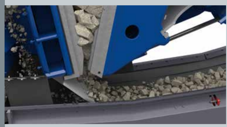
Prallplatte und Materialtunnel
