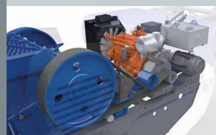
Brecher-Direktantrieb via Fluidkupplung
