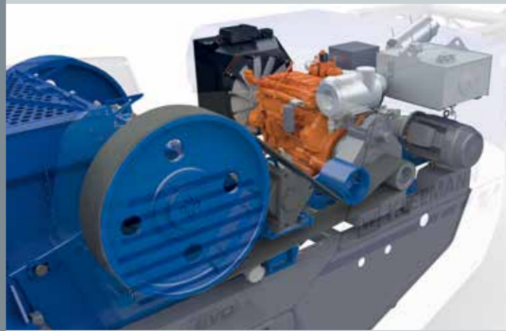
通过液力耦合器直接驱动破碎机
