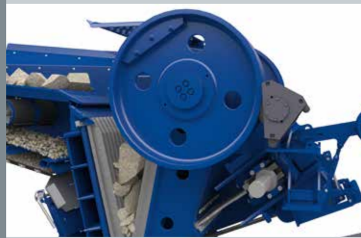
Système de déblocage du concasseur
